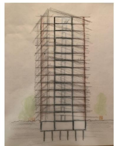
Als Tragwerk: braun: tragende Baubuchestützen in den Außenwänden und Holzbeton Verbunddecke; grau: Betonkern Treppenhaus
